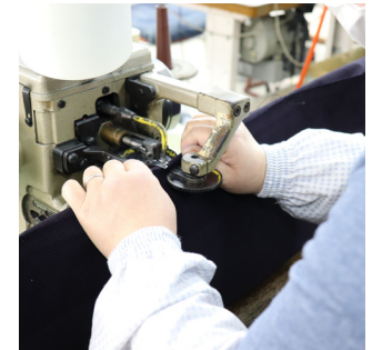
面の工程 綿を入れた面布団の端をミシンで縫う。
