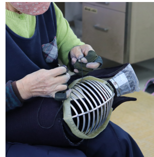
面の工程では、面布団と面金を水牛の皮を取り付ける作業を行う。水牛の皮は乾くと堅くなるため、縫う作業はスピードを要する。
