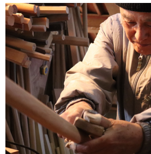
職人によるカンナ仕上げ 熟練した職人が数種類のカンナを使い分け、一本ずつ丁寧に仕上げる。
