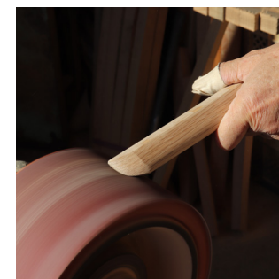
磨き仕上げ 数種類のパーパーを使い磨き仕上げを行う。
