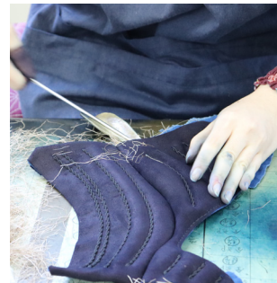
甲手の工程 鹿の毛でできた綿を入れる。
