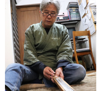
羽焼き 焼き羽と竹の接着面をつきやすくする。
