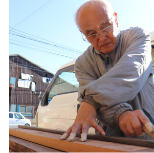
線引き 材料に使用する部分に節や傷がからまないように慎重に線引きする。
