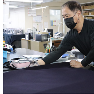
裁断 裁断は専用の機械を使用して、ミリ単位で正確に、ぶれないように一瞬で行う。
