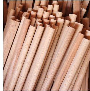
天日乾燥 歪みや曲がりの出ないように原材料を天日で一年以上の乾燥を行う。
