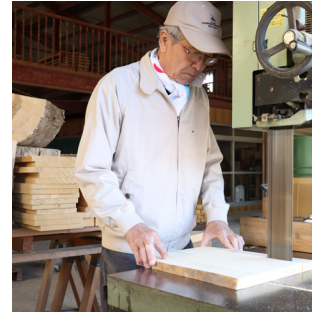
製材(木取り)。 碁盤→将棋盤→卓上将棋盤→まな板 →箸・木べらの順にとっていく。
