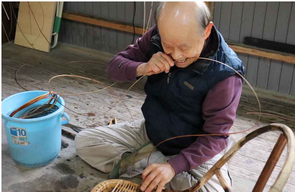
曲げの工程 バーナーで熱しながら製図面に合わせて少しずつ曲げていく。
