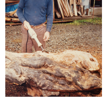
製材の工程 原木から切り取り、かなやかき取り機で形を整える。計測も行う。
