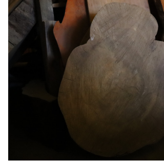
材料を乾燥させる工程 天日で約5~15年以上乾燥させる(木の大きさによる)。完全に乾燥させないと木が曲がる。
