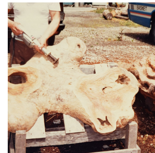
縁型作りの工程 かき取り機で形を整えていく。
