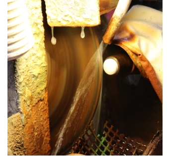
砥石に水をかけて冷やしながら碁石独特の曲面を作る。熟練の技と経験が不可欠である。
