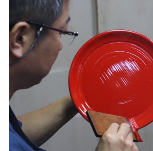
上塗りの工程 下地付け→下地研ぎ→中塗り→研ぎを経て、精製し純度を高めた漆を塗る作業。
