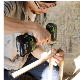
台組みの工程 曲げが終わったパーツを組み合わせていく。
