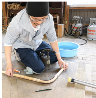
曲げの工程 バーナーで熱しながら製図面に合わせて少しずつ曲げていく。
