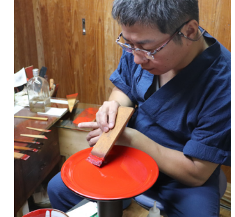
上塗りは塗装の最終工程であり、ロクロを回しながら丁寧に塗る。
