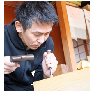
4つの脚を取り付ける。 少しずつ彫りながら調整をしていく。
