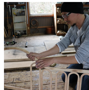
研磨 台組みしたものを磨いていく。
