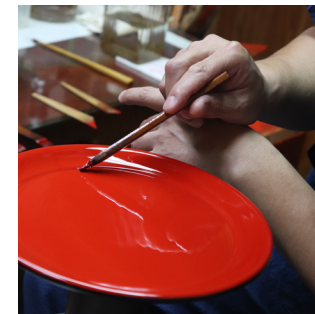
最終工程のため、チリやホコリが付かないように最新の注意を払いながら塗る。最新の注意を払うために、作業時は部屋を閉め切り、温度、湿度を一定に保つ。
