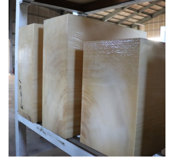
割れ止めを何度も何度も塗り重ね、水が抜けるまで乾燥させる。厚いもので約10年、薄いもので約5年寝かせ、自然乾燥させる。木は生きており、曲がることがあるので、乾燥後は曲がった箇所を修正するなど再度木取りを行う。
