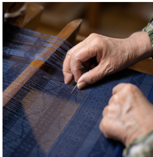
少し織っては、たて糸のズレを針で直したて糸の張り具合を調整する。
