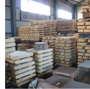
割れ止めを何度も何度も塗り重ね、水が抜けるまで乾燥させる。厚いもので約10年、薄いもので約5年寝かせ、自然乾燥させる。木は生きており、曲がることがあるので、乾燥後は曲がった箇所を修正するなど再度木取りを行う。
