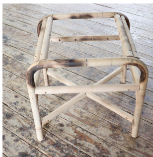
台組みの完成品
