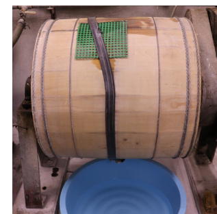
樽磨きの工程 碁石と碁石が擦れ合い、碁石の表面の凹凸が少しずつ磨かれる。最後に蠟で表面を薄くコーティングして完成。
