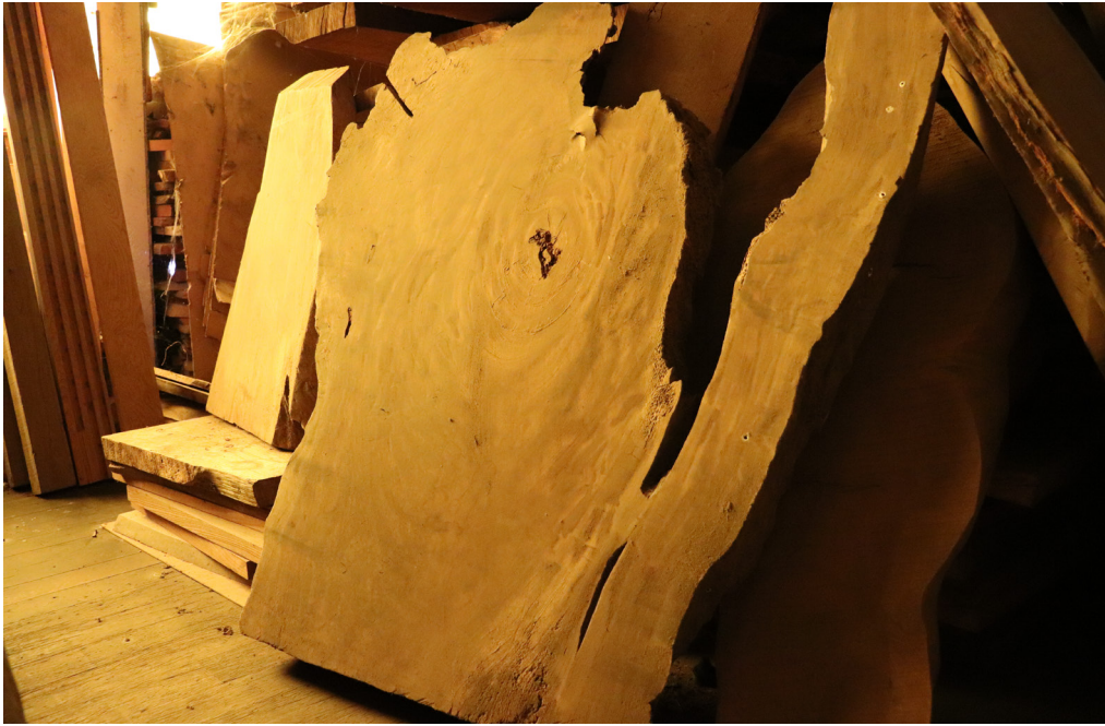
材料を乾燥させる工程 天日で約5~15年以上乾燥させる(木の大きさによる)。完全に乾燥させないと木が曲がる。
