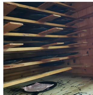
上塗りの乾燥の工程 漆を乾燥させるための最適な温度と湿度を保てる漆室の中に入れて乾燥させる。
