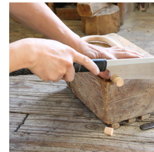
台組みの工程 少しずつカットして長さを微調整していく。
