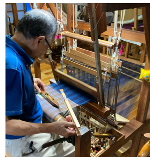
設計図どおりの本数や順番になっているかチェックしながら櫛で糸を整え、織りの作業に入る。
