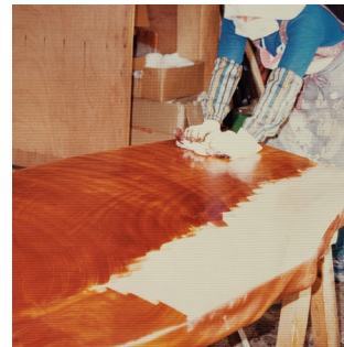
漆塗装の工程 ハケで塗り、布で拭く工程を約8回繰り返す。
