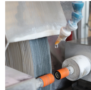
端引き 碁石の耳の部分のわずかな角をなめらかにする。
