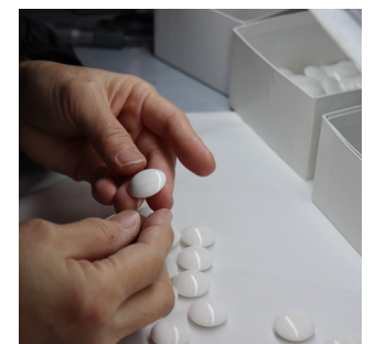
碁石の選別 人の目で1つ1つ選別する。品質選別…キズ、色、形などを見る。グレード選別…縞目、白さ。
