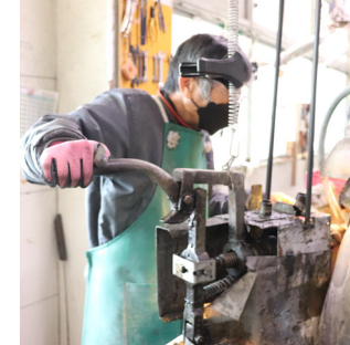
摺りの工程 荒摺り→中摺り→手摺りの3回行う。
