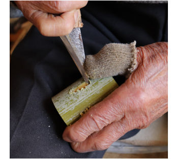
小さな穴を繋げ、縦長に穴を開け風切り窓を作る。笛のように中を少し斜めに彫る。
