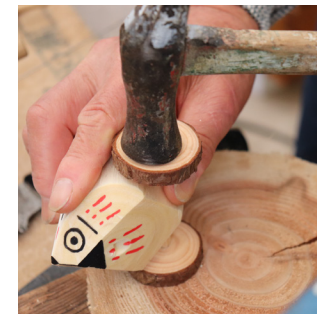
金づちで車輪を打ちつけて固定する。
