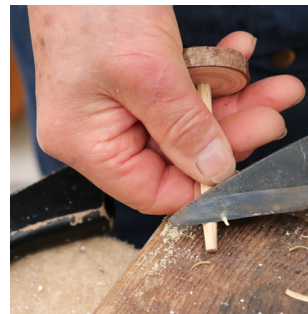
竹ひごの先端をナイフで細く削り車輪に押し込む。
