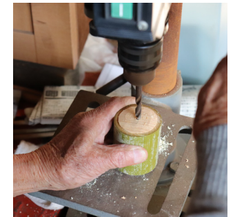
独楽の心棒を取り付けるために、ふたの中央に穴を開ける。
