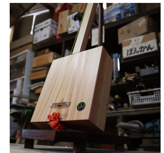
完成品 糸倉、棹、糸巻き、糸、胴箱、上駒、下駒、音緒、全ての材料がそろったら組み立てて完成させる。
