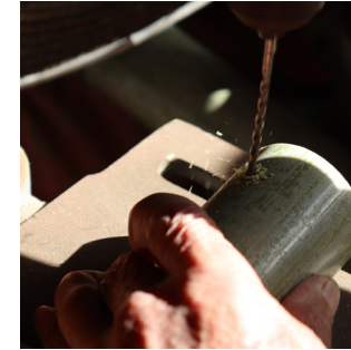
風切り窓を作るために数カ所、小さな穴を開ける。
