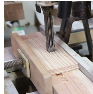
棹を差し込む穴を開ける。
