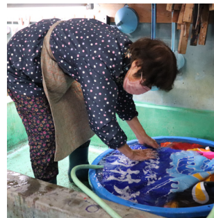
水洗い 色止め、熱処理した後、半日程水につけ糊を洗う。
