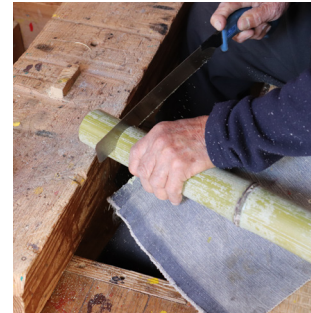
独楽の胴体の大きさにするよう竹を切る。
