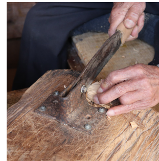
手作りの専用機械でふたを円状に削る。細かい所は手彫り。
