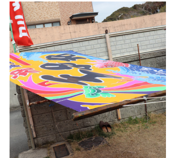
乾燥 天日干しで色止めをする。天気が悪い日は熱を加え熱処理する。
