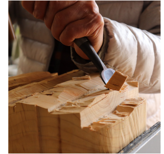
設計図に基づいて計算された高さになるように彫る。
