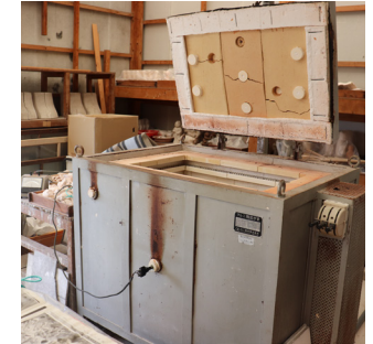
窯 型入れ後、乾燥させたものを窯で焼く。粘土をいれる。
