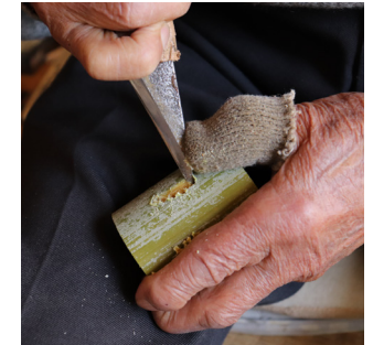
小さな穴を繋げ、縦長に穴を開け風切り窓を作る。笛のように中を少し斜めに彫る。
