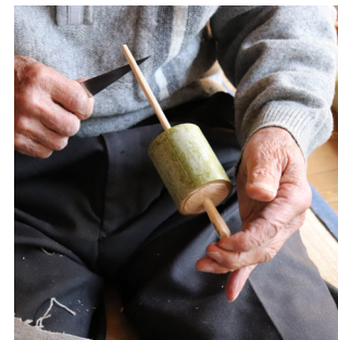
心棒を取り付ける。でこぼこしている方が糸が巻き付きやすい。機械にはできない手業。
