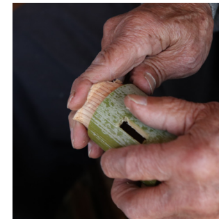
ふたが大きい場合は再度削りながら調整する。
