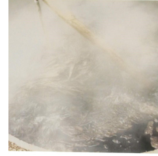
煮方 楮皮を釜に入れ、苛性ソーダを加え柔らかくなるまで煮る。
