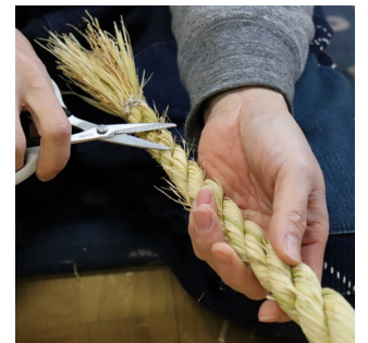
まっすぐに均等になるよう手で押さえながら整えたあと、余分な部分をカットする。
