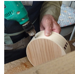
穴をあけ、竹串で側板と底板を留める。
