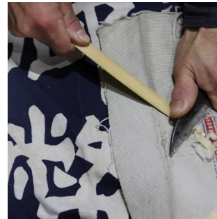
補強となる縁を作る。 表と裏を丁寧に剥ぎながら薄くする。
