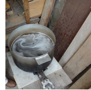
側板のひのきの板を茹でて曲げやすくする。
