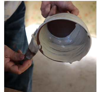
約10時間の素焼きのあと、釉薬掛けを 行う。 ハケを使って大胆に釉薬を掛ける。色 をつける大事な作業。
