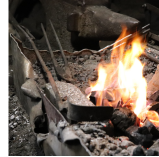
火を起こした木炭で金属を焼く(温度が800°C近く上がる)。
