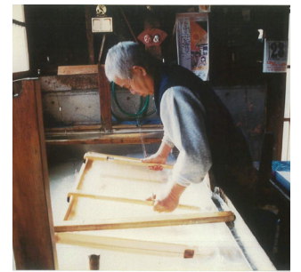
紙漉き 水の入った漉き槽に紙料を入れ、笄により紙を漉く。
