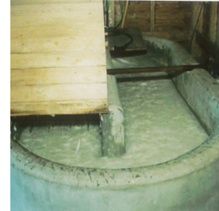
ねり 叩解した楮皮に「のりうづぎ」を加えかき混ぜる。
