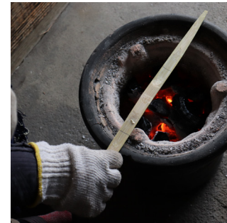
縁を曲げる。 底縁の角は七輪であぶって曲げる。修業で得た感覚で温度を見極め、少しずつ曲げる。
