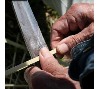
はぎ 竹の内側の余分な肉を剥ぎ取る。さらに表皮のみを残して刃物を入れ、「ひご」を作る。
