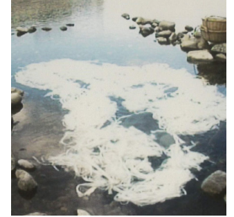
あく抜き 柔らかくなった楮皮を清流にさらし、ソーダ分を抜く。
