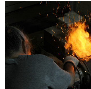
本焼きは5日かけて焼くため寝らずに 行う。本焼き後、3日ほど寝かせて窯出 しを行う。
